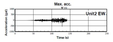
UNIT 2 ACCELEROMETER RECORD OF THE 11 MARCH 2011 EARTHQUAKE - TEPCO
